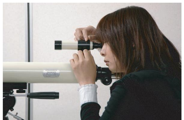
一番低倍率の接眼レンズ(接眼レンズの焦点距離の数値が大きい)を望遠鏡の接眼部に取り付け、1キロ以上先の目標物を天体望遠鏡の視界の中心に置きます。
