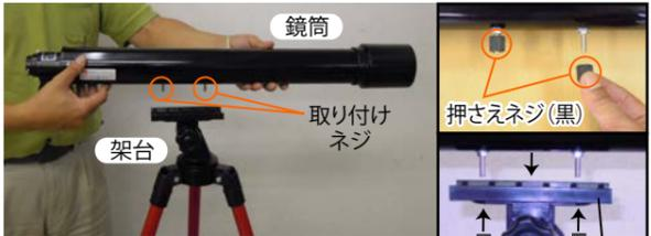
鏡筒の取り付けネジから、押さえネジ(黒)を一度外します。架台(かだい)の筒(つつ)受けの2つの穴に、取り付けネジが2本ともさしこむように鏡筒をのせます。筒受けにさしこまれた取り付けネジに、筒受けのうらがわから押さえネジ(黒)をつけて、しめつければ取り付け完了です。
