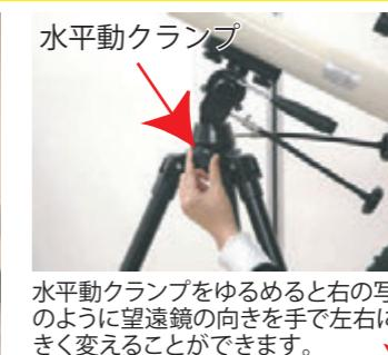
水平動クランプをゆるめると右の写真のように望遠鏡の向きを手で左右に大きく変えることができます。
