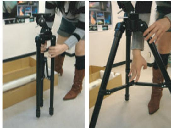
三脚を取り出し、三脚の開き止めステーが完全に伸びるまで三脚を開きます。
