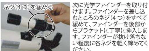
次に光学ファインダーを取り付けます。ファインダーを差し込むところのネジ（4つ）をすべて緩めて、ファインダーを後部からブラケットに丁寧に挿入します。ファインダーが抜け落ちない程度に各ネジを軽く締めてください。
