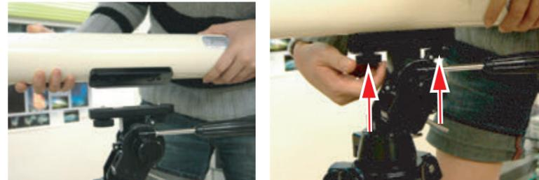
箱から望遠鏡を取り出し、経緯台（架台）上部の筒受け部に取り付けます。筒受け部の前後のネジをしっかりと手締めします。
