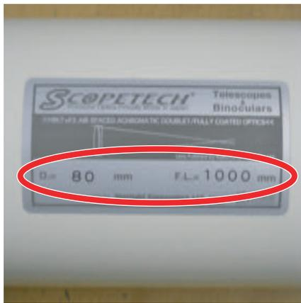
望遠鏡の鏡筒に書いてある「D=80mm」は対物レンズの直径、「F=1000mm」は対物レンズの焦点距離です。
